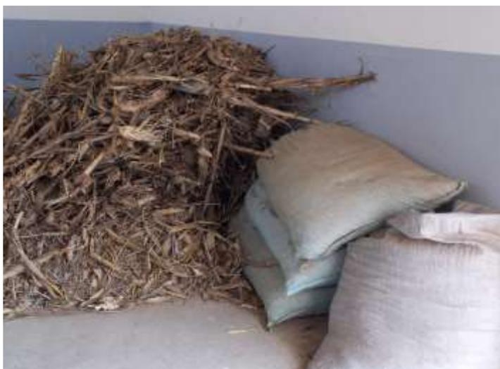
Fig. 1- Palha de milho como matéria de prima de produção do biochar
