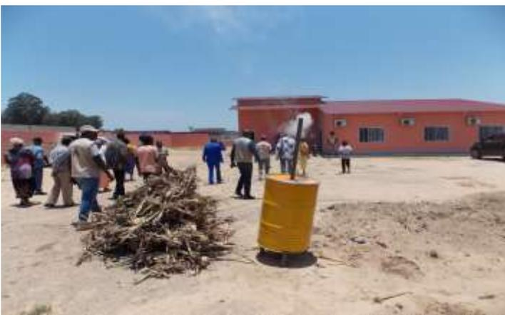
Fig. 7. Acender o forno e aquecer a biomassa
